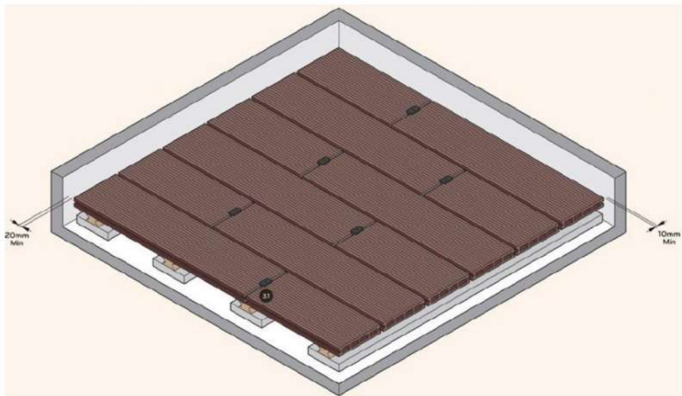
Obr. 7 – pokládka WPC desek s dodržением dilatačních mezer
