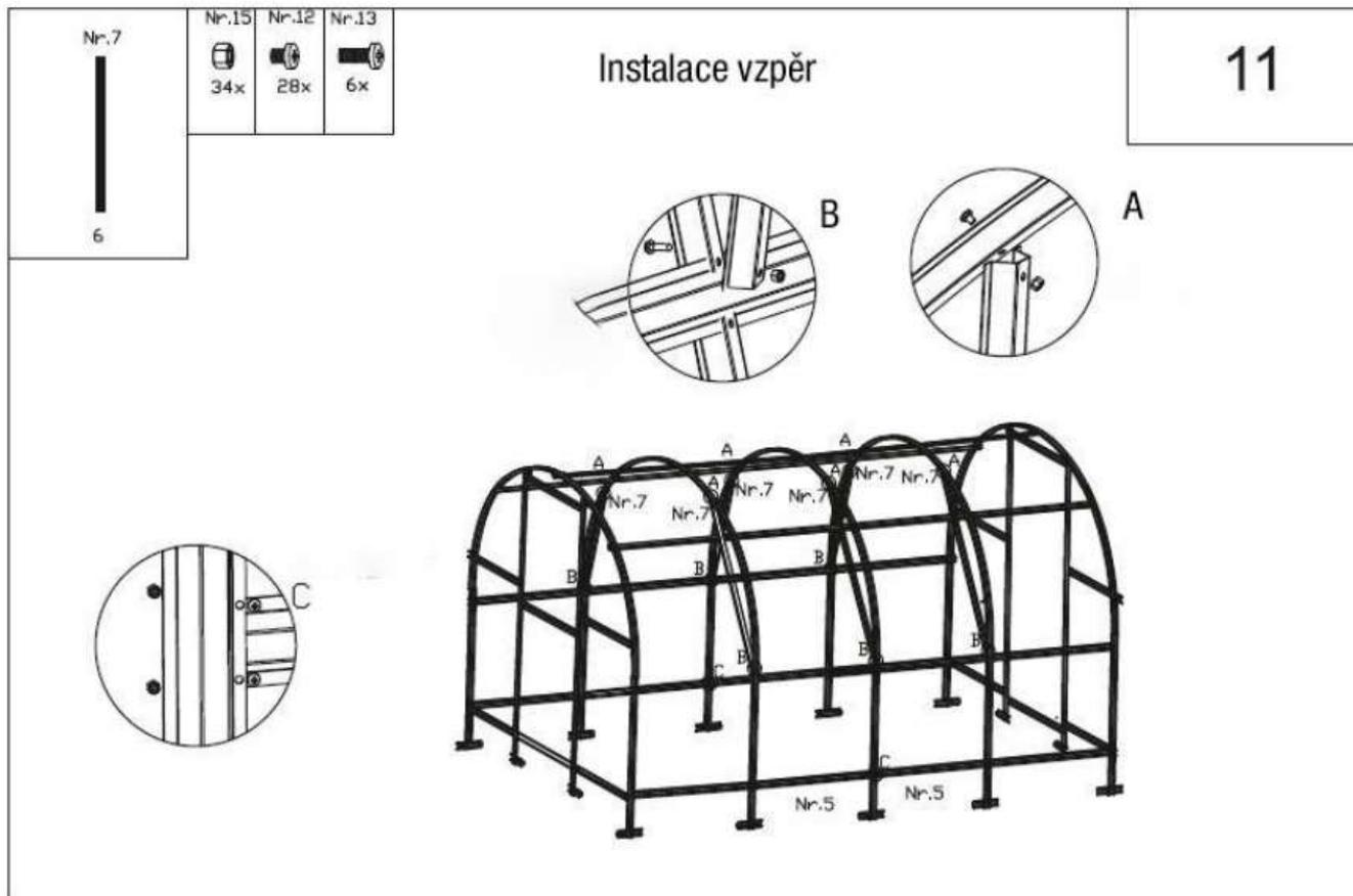
8. Upevňovací úhelníky (18) jsou přišroubovány k výztuhám oblouků – bočnicím (č. 6) v přední a zadní straně (v čelech). **Obr. 12.**
